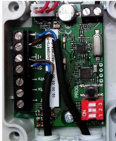
Bilde 17: Tilkobling av medbevegende klemmevern til JCM-senderen RB3R686
