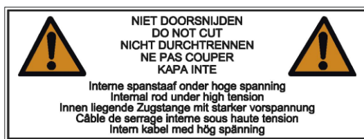
Bilde 3: Varselklistremerker på underligger
